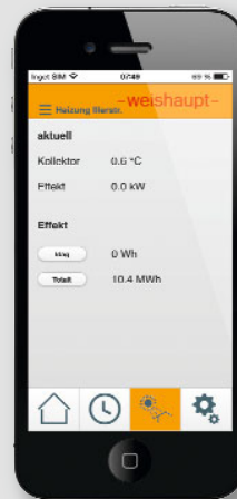
Display över ärvärden för en ansluten solfångaranläggning
